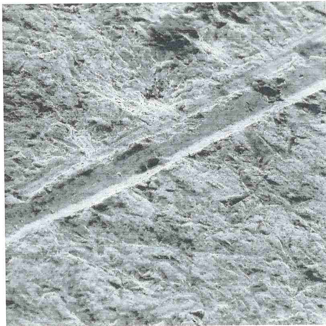
Figura 4-10 – Defeito causado pela passagem do abrasivo. Aumento de 323x.
