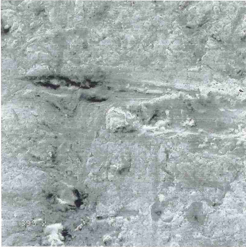
Figura 4-13 – Região desgastada por sulcamento. Aumento de 395x.
