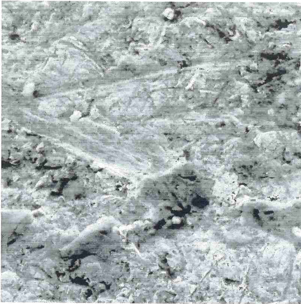
Figura 4-12 – Defeito superficial com acúmulo do material deslocado. Aumento de 950x.
